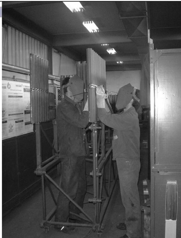
**Vježba zavarivanja na specijalnim napravama za kombinirane postupke**
