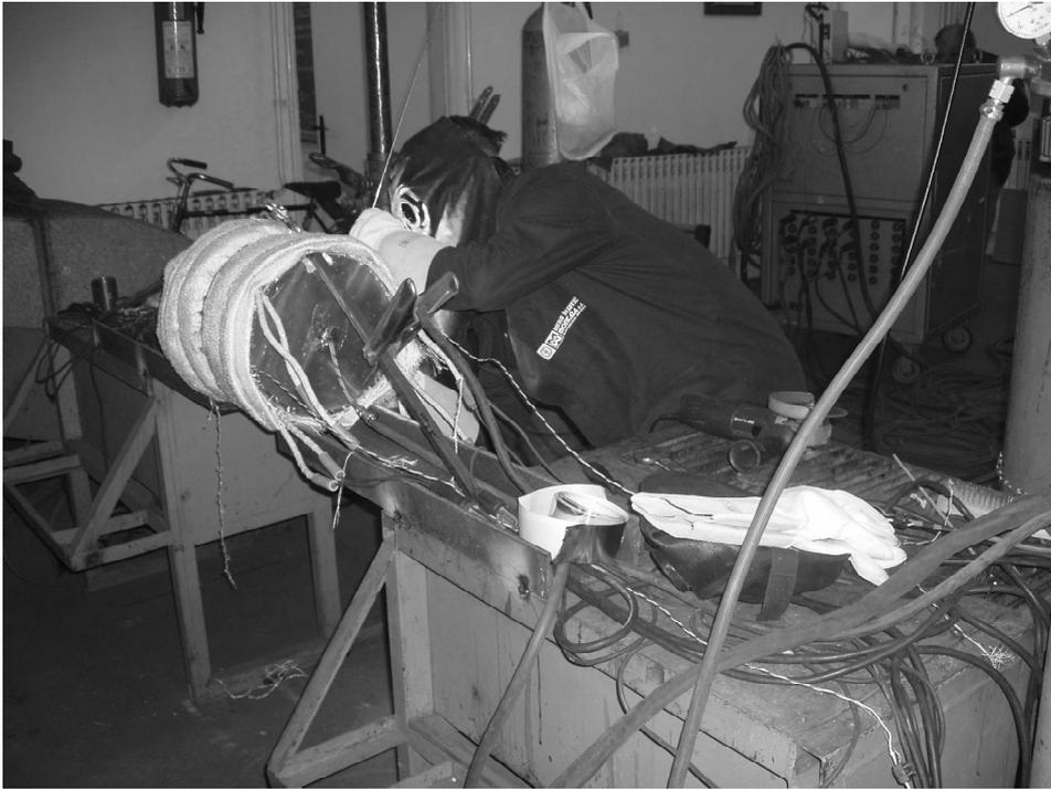
**Provođenje uvježbavanja zavarivača za planirane kvalifikacije postupaka zavarivanja sa izvođenjem toplinske obrade i upuštanjem inertnog - zaštitnog formir plina N2H2**
