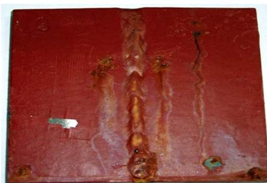
Slika 3. Izgled uzorka poslije ispitivanja u slanoj komori
