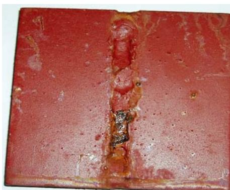
Slika 2. Izgled probnog uzorka nakon 84 sata ispitivanja
