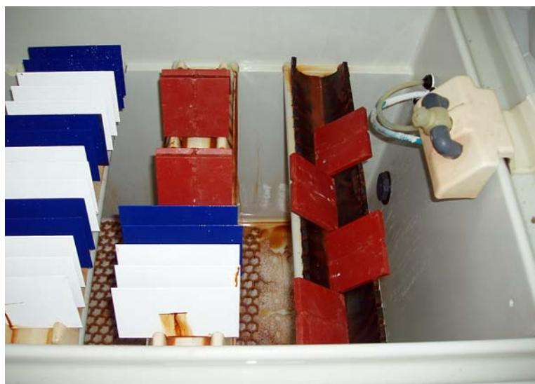
Slika 1. Probni uzorci u slanoj komori
