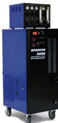
Slika 5. Izvor struje za rezanje finim lukom plazme sa smanjenom emisijom štetnih plinova
