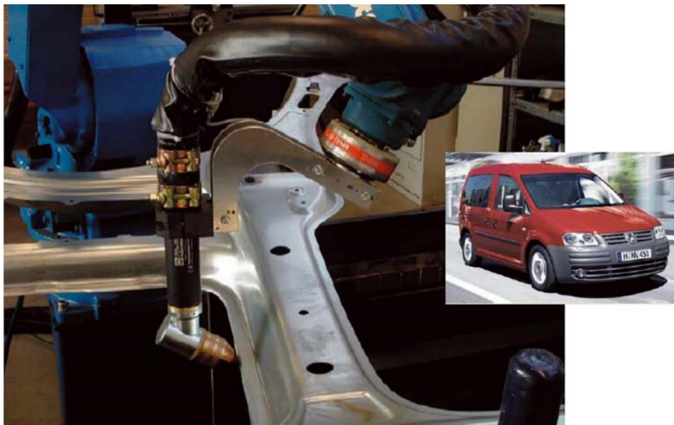
Slika 9. Izrezivanje ruba prednjeg vjetrobranskog stakla na VW Caddy
