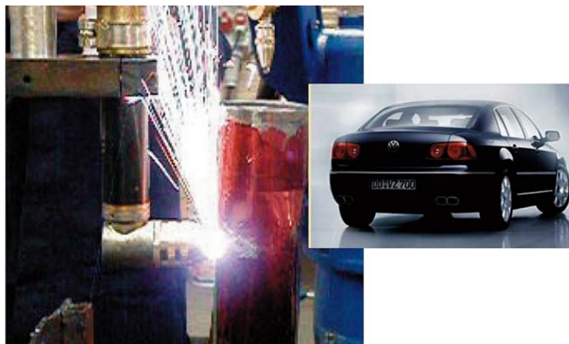
Slika 11. Izrez provrta na ispušnoj cijevi (aluminij 4 mm) VW Phaeton
