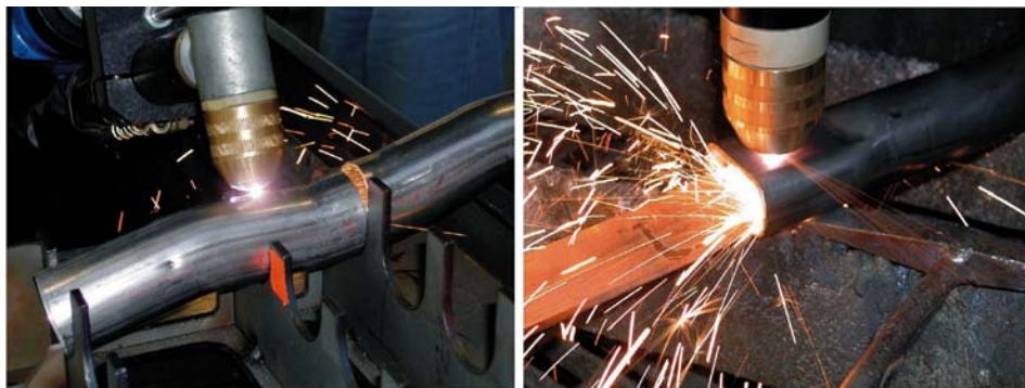
Slika 10. Primjer izrade provrta na ispušnom sustavu (za lambda sondu)
