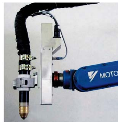
Slika 7. Gorionik PerCut160-2 montiran na robotsku ruku s 5 stupnjeva slobode gibanja
