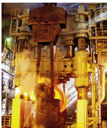
Slika 3. Operacija slobodnog prekrivanja debelostjenih prstenova plašta u svrhu prekrizacije primarne lijevane u kovanu strukturu
