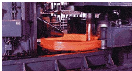
Slika 4. Toplo valjanje prstena ( 1200 °C do 800 °C) na željeni unutrašnji promjer (100 – 8000 mm) i visinu do max. 1500 mm. Težina radnog komada do 10 t.
