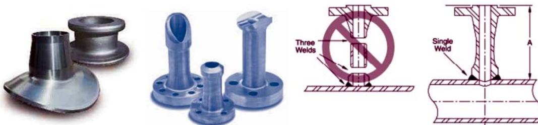
Slika 8. Primjer otkovanih i strojno obrađenih priključaka s ojačanjem i prijelazom na zadani radijus plašta posude
