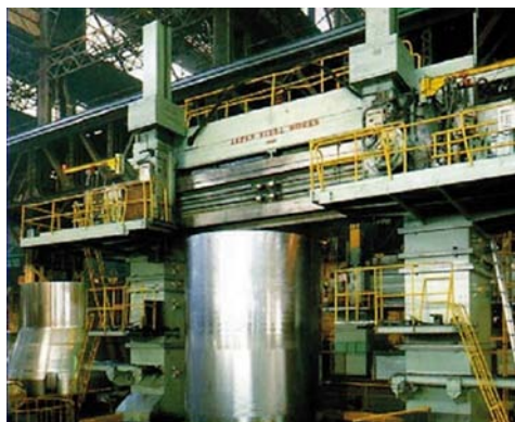
Slika 5. Strojna obrada vanjskog i unutrašnjeg promjera plašta i izrada priprema za zavarivanje kružnih zavara. Tolerancija unutrašnjeg promjera je \pm 1 mm prema ISO 2768-mK
