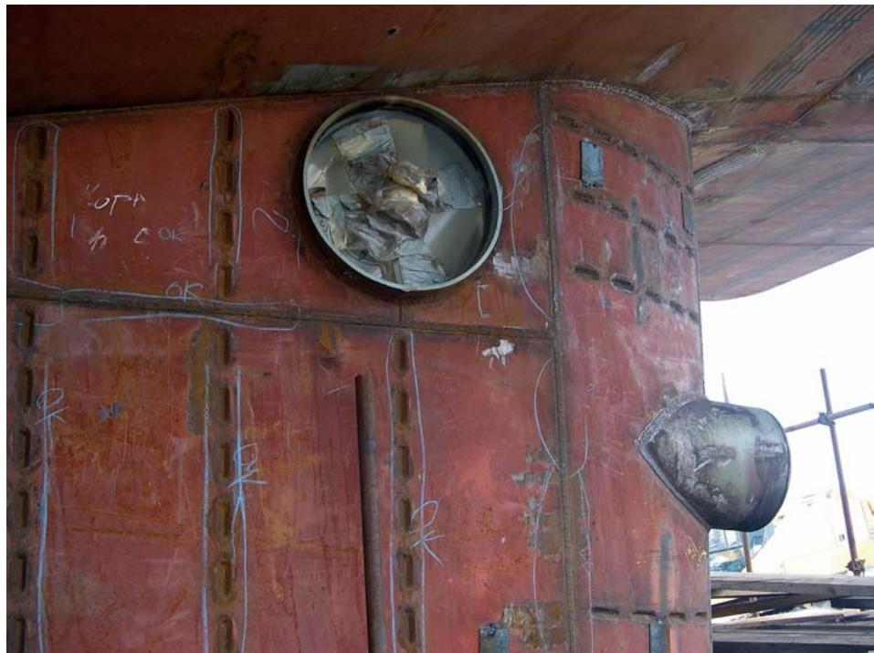
Slika 2. "Ažule" na oplati tunolovca, gradnja 59
