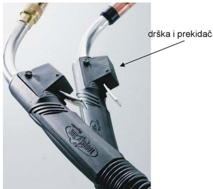
Tregaskiss je patentirao spiralni uvodnik **"Quick Load Liner"** za čiju izmjenu nije potrebno skidati polikabel sa dodavača niti namatati žicu natrag u dodavač žice.
