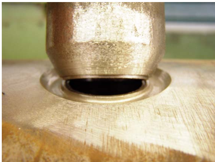
Slika 7 Postavljanje priključka u žlijeb na komori
