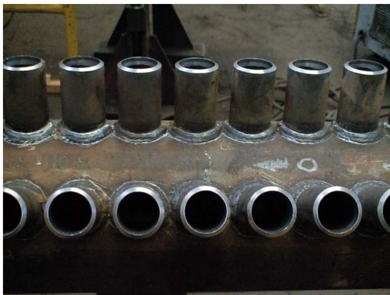
Slika 1 Sabirnica s ručno zavarenim priključcima
