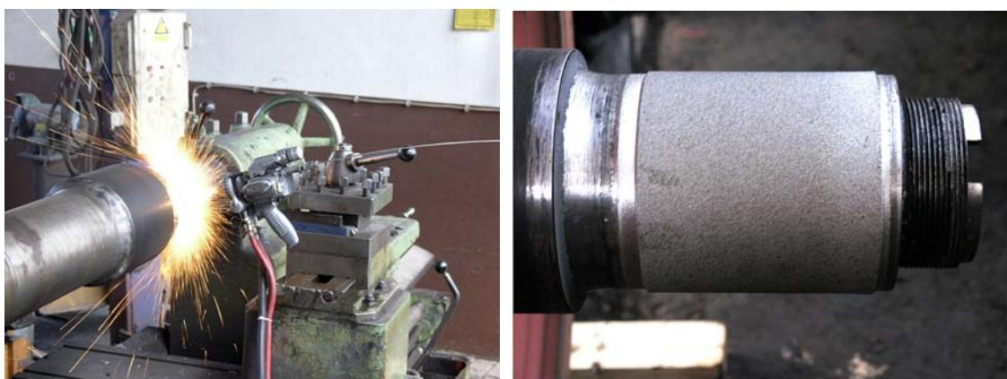
Slika 6. Postupak toplinskog naštrcavanja plamenom gorivog plina i naštrcani rukavac osovine
