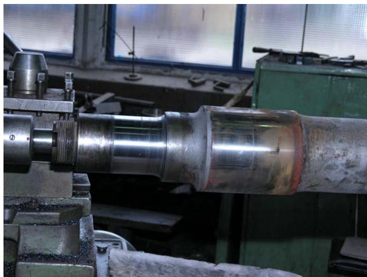
Slika 4. Rukavac osovine oštećen zakretanjem unutarnjeg prstena kotrljajućeg ležaja po rukavcu
