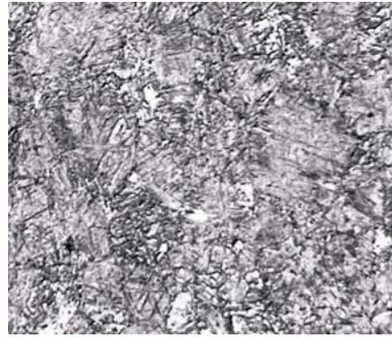
Slika 5. Mikrostruktura ZUT-a čelika TStE 420 povećanje 200 x, \Delta t_{8/5} = 10 s
