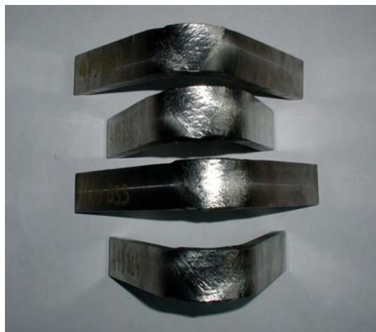
Slika 11. Epruvete bočnog savijanja
