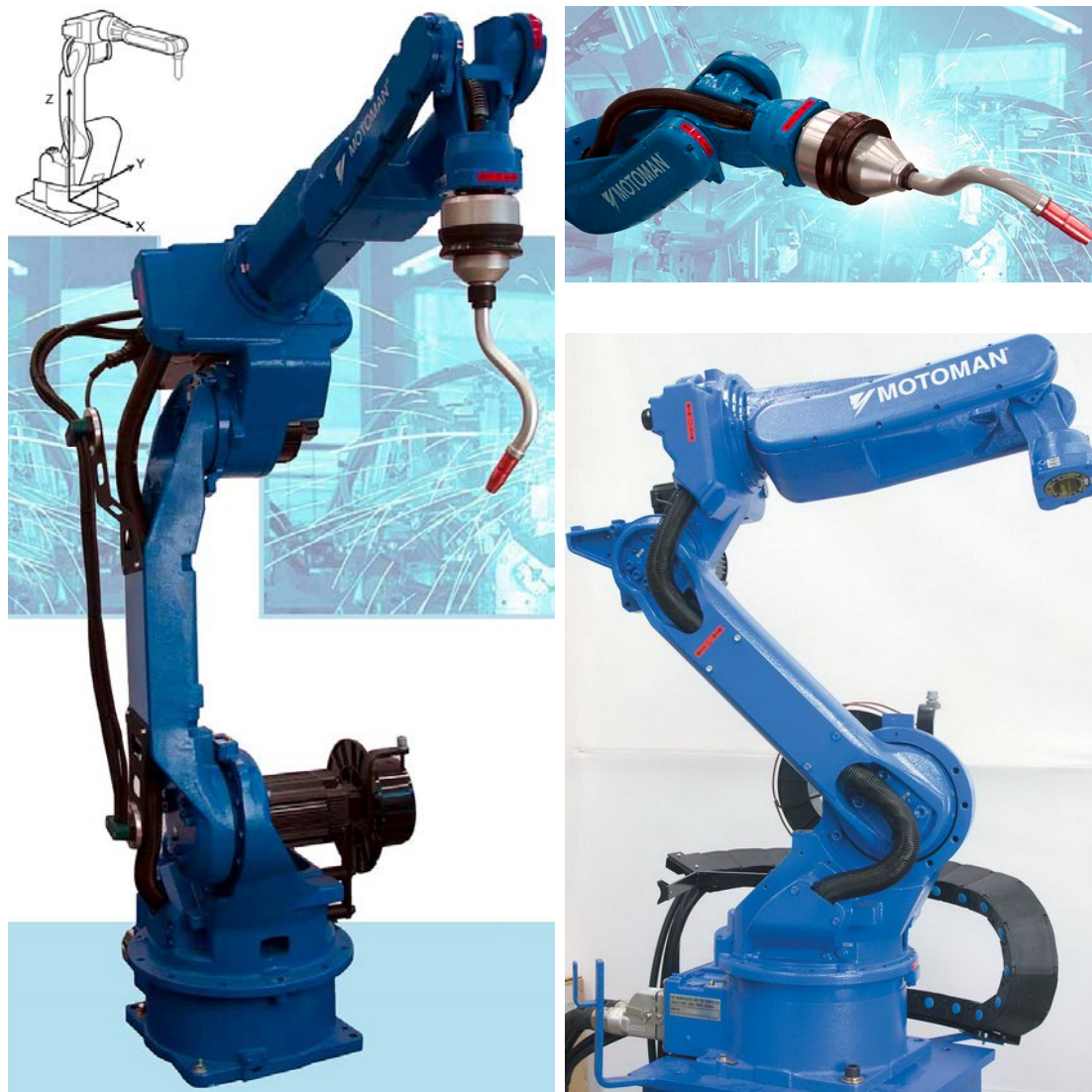
Slika 1. Robot za zavarivanje MOTOMAN - EA1400N s prikazom koordinatnog sustava XYZ (veza s tablicom 3) [6]
