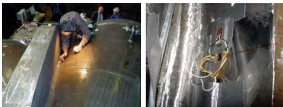
Slika 5. Lijepljenje mjernih traka i montaža kablova
