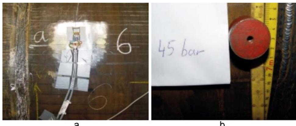
Slika 7. Mjerne trake na najopterećenijem dijelu račve - POSITION 6 (a) i pojednostavljen način ocjenjivanja cijelokupne deformacije cilindričnoga dijela račve (b).
