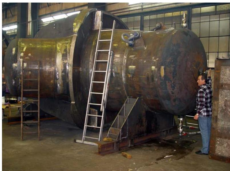
Slika 1. Račva na mjestu za izvođenje tlačne probe
