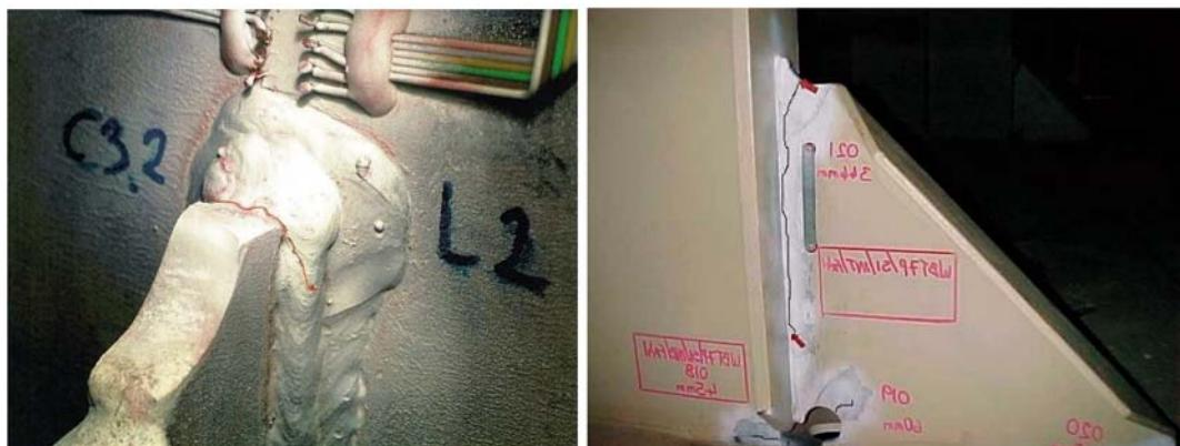
Slika 3. Zamorna pukotina na zavarenom spoju rebra za ukrućenje
