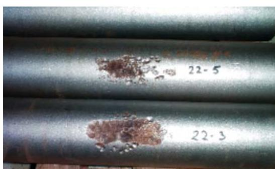
Slika 4. Korozija vanjske površine cijevi
