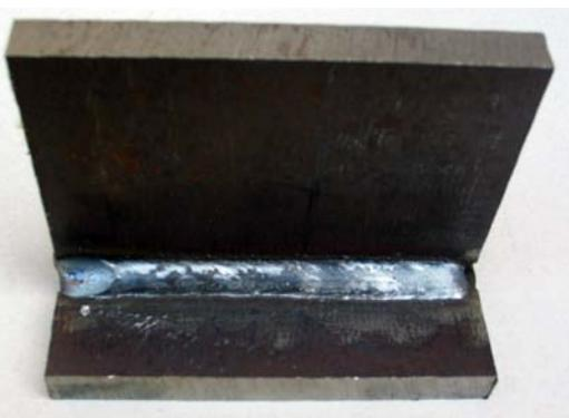
Slika 5. Zavar s Filtub 32M bez čišćenja nakon zavarivanja
