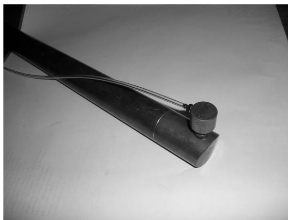
Slika 4. Gibljiva elektroda s mogućnošću dovođenja zaštitnog plina
