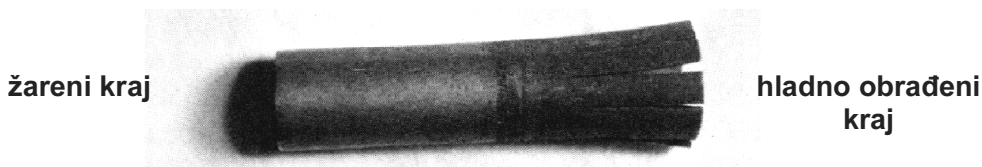
Slika 27. Pukotine uslijed napetosne korozije hladno obrađenog kraja cijevi [2]
