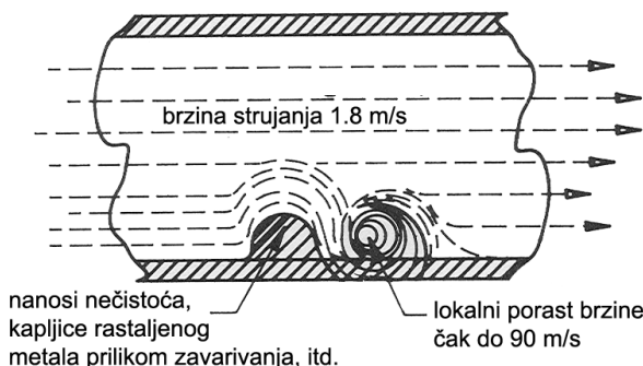
Slika 19. Nanosi nečistoća, kapljice rastaljenog metala zbog prskanja prilikom zavarivanja itd., ubrzavaju erozijsku koroziju [2]
