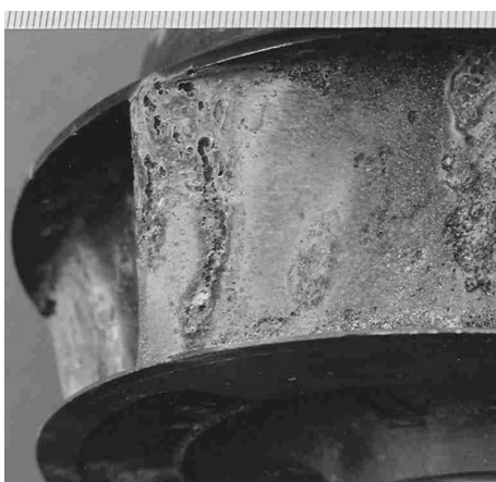
Slika 18. Erozijsko – korozijsko oštećivanje rotora pumpe tvrdim česticama
