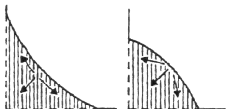
Slika 28. Oblik zavora i raspored površinskih vlačnih napreznja [7]
