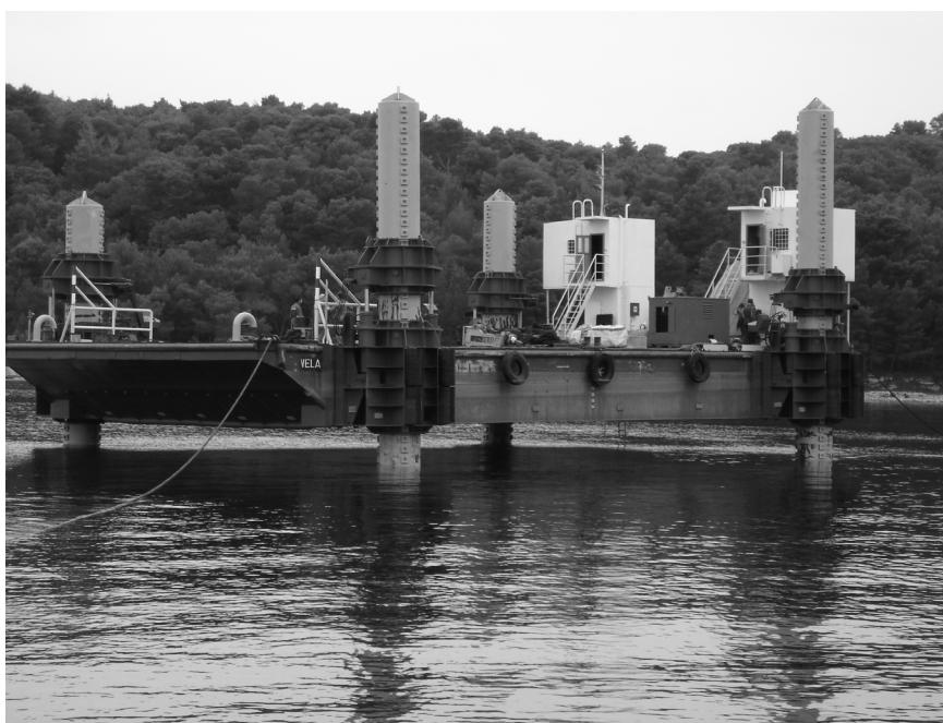
Slika 2. Na slici se vide platforma sa vodilicama i jarmovima
