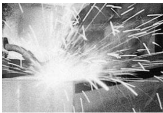
Slika 3. MAG zavarivanje s Ar/CO 2 82/18 i Ar/O 2 96/4
