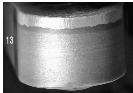
Slike 7. i 8. Uzorci nakon ispitivanja savijanjem ( 1 i 2 – neodžareni; 13 – odžaren )
