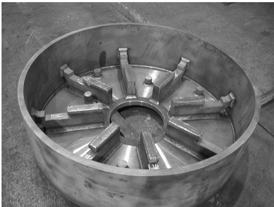
Slika 2. Donji dio tlačne posude ( \varnothing 1261 \times 300 )
