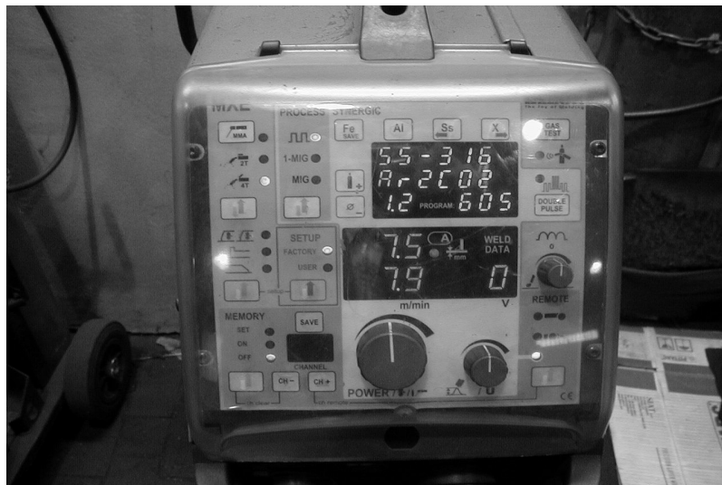
Slika 4. Odabir parametara zavarivanja na upravljačkom panelu MXE
