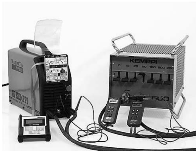
Slika 4. Mjerna oprema za umjeravanje uređaja za zavarivanje
