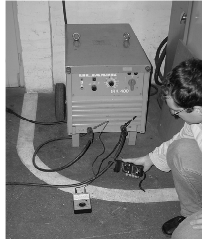
Slika 1. Mjerenje napona i struje zavarivanja pomoću voltmetra i strujnih kliješta
