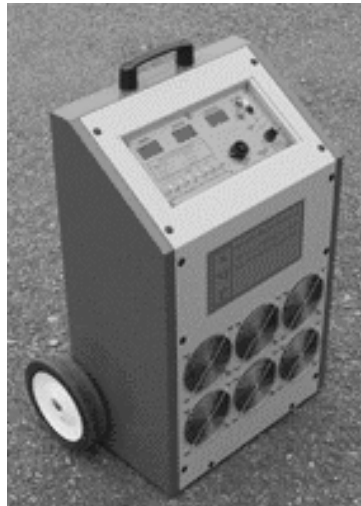
Slika 5. Mobilni mjerni sustav za umjeravanje i provjeru uređaja za zavarivanje
