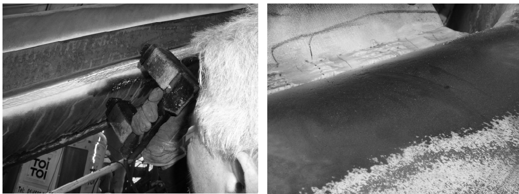
Slika 10. Ispitivanje zavarenih spojeva
