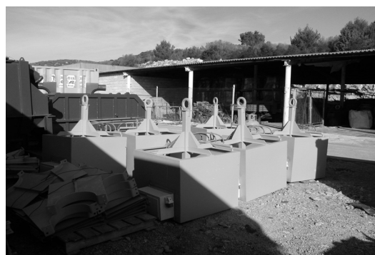
Slika 7. Grijači za predgrijavanje i kade za grijanje butanskih boca
