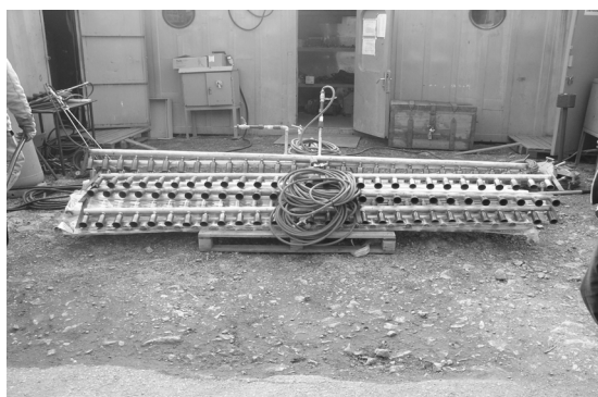
Slika 7. Grijači za predgrijavanje i kade za grijanje butanskih boca
