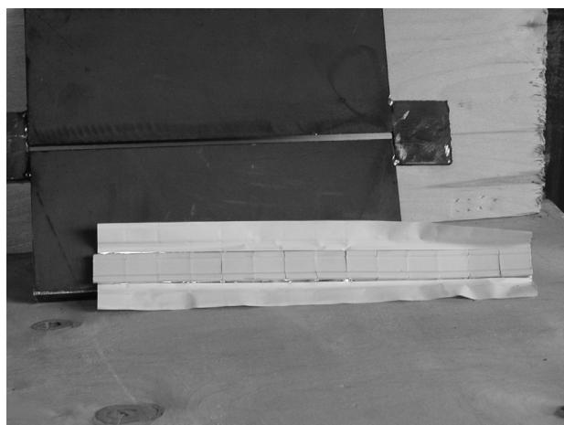
Slika 2. Keramička podloga za zavarivanje Al-folijom
