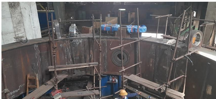
Slika 5. Proces blokovanja obrtnog prstena
