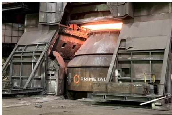
Slika 14. Kiseonikov konvertor BOF nakon montaže i probnog rada
