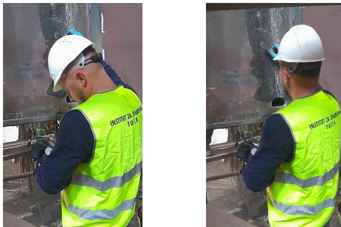
Slika 13. Ultrazvučno ispitivanje zavarenog spoja
