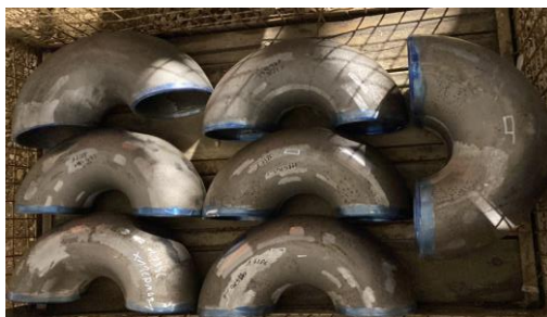
Slika 4. Pripremljena koljena za zavarivanje na montaži
