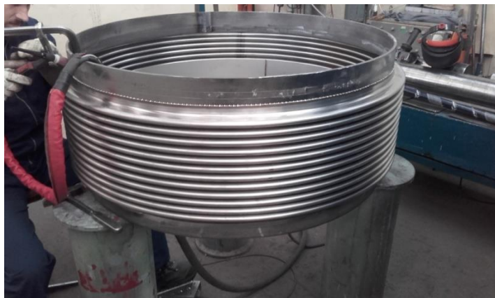
lika 3. Pripajanje tankostijene harmonike na cijevni nastavak
