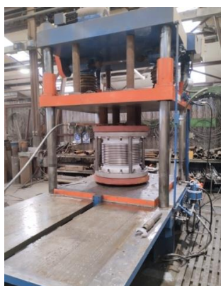
Slika 9. Hidraulična tlačna proba (lijevo) s prikazom manometra (desno)
