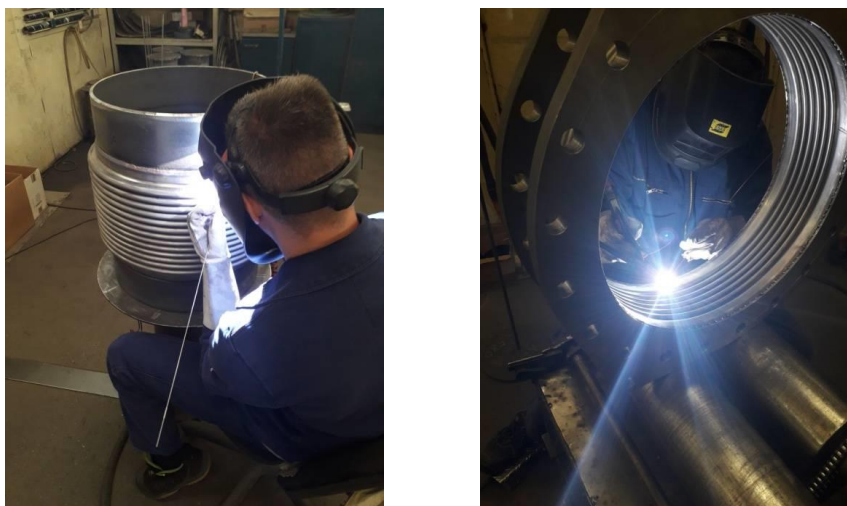
Slika 2. Vanjski spoj harmonike na cijev (lijevo) i unutrašnji spoj harmonike na prirubnicu (desno)
