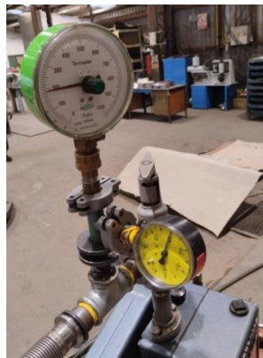
Slika 8. Vakuum test (lijevo) s prikazom manometra (desno)
