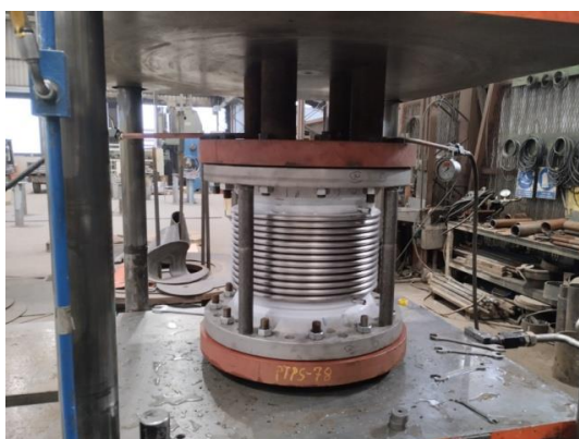
Slika 9. Hidraulična tlačna proba (lijevo) s prikazom manometra (desno)
