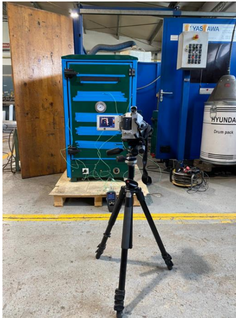
Slika 6. Snimanje zagrijanosti velike peći za sušenje elektroda
