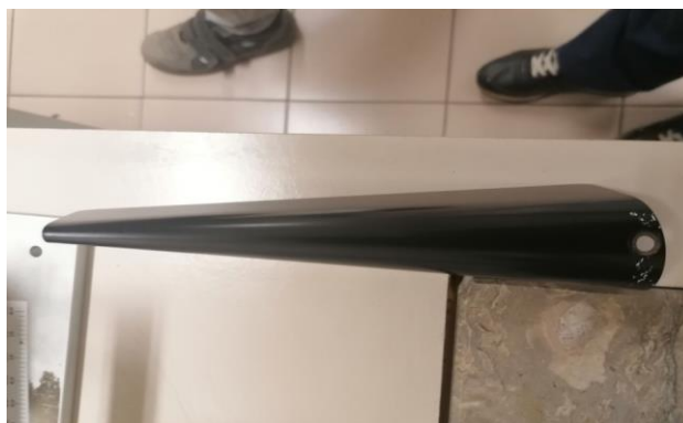
Slika 7. Ispitni uzorak nakon provedenog savijanja
