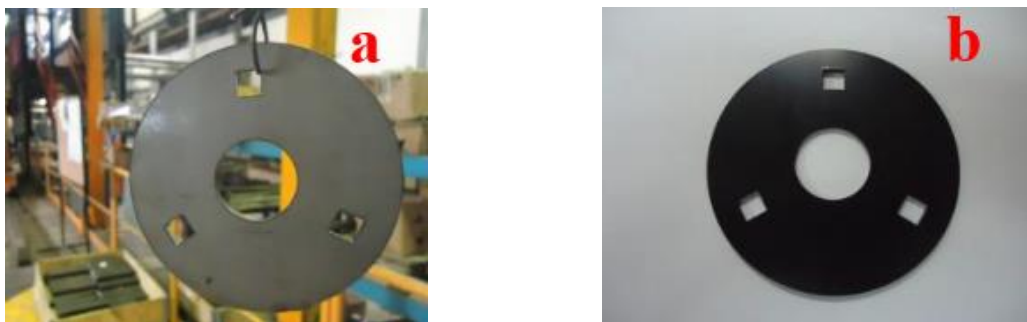
Slika 3. Prikaz pozicije prije (a) i nakon (b) aplikacije zaštitnog premaza postupkom kataforeze
