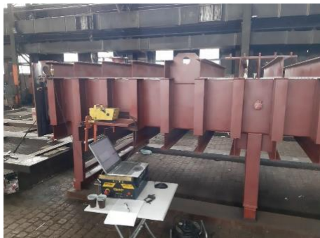
Slika 8. Konstrukcija vakuum peći s opremom za provođenje VSR procesa
