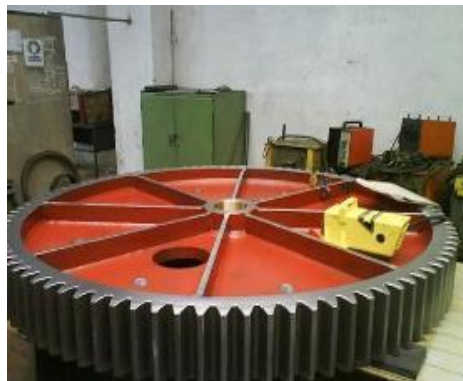
Slika 2. Korištenje VSR metode kod saniranja zupčanika
