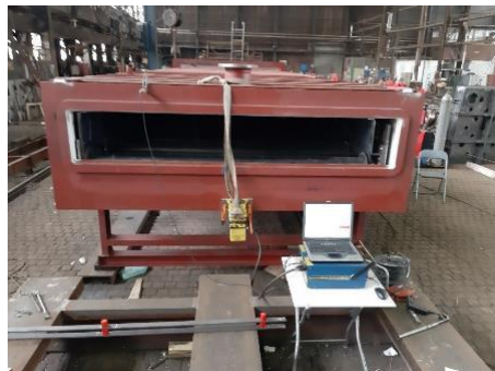
Slika 9. Konstrukcija vakuum peći - čeonice i oprema za provođenje VSR procesa
