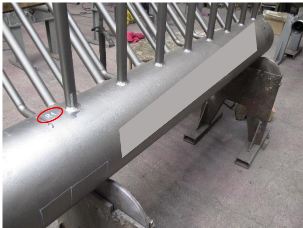
Slika 2. Ispitna cijev br. 1 s označenim mjestom ispitivanja (lijevo) i nanesenom folijom za repliciranje (desno)
