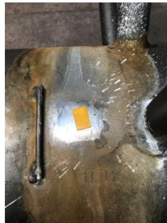
Slika 2. Ispitna cijev br. 1 s označenim mjestom ispitivanja (lijevo) i nanesenom folijom za repliciranje (desno)
