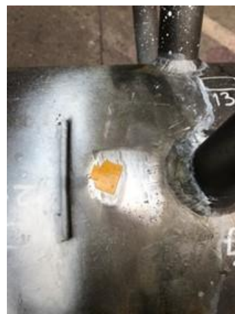
Slika 4. Ispitna cijev br. 2 s označenim mjestom ispitivanja (lijevo) i nanesenom folijom za repliciranje (desno)
