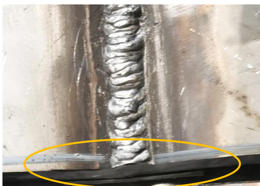
Slika 5. Proba zavarivanja - neprotaljena podloška
