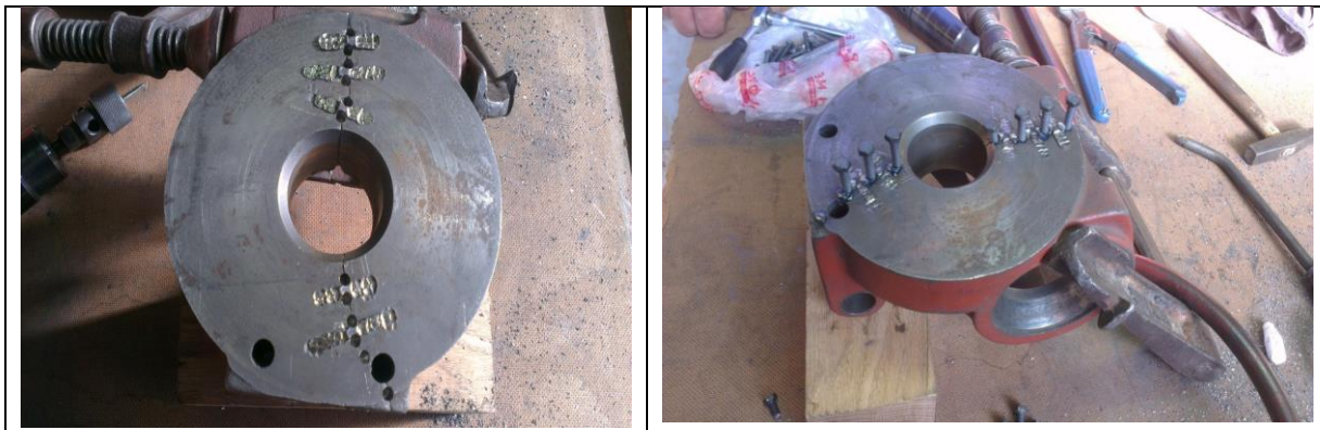
Slika 7. Bušenje rupa za METALACE vijek i postavljanje METALACE vijaka. [2]
