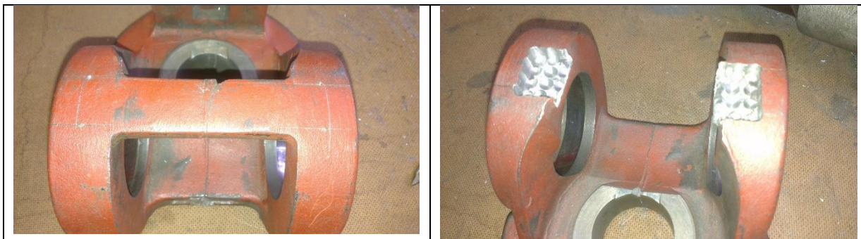
Slika 9. Obilježavanje i odvajanje materijala kao priprema za postavljanje METALOK pločice. [2]
