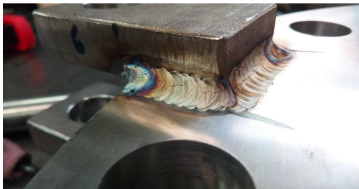
Slika 1. Primjer hladne (a) i tople kristalizacijske pukotine (b) u zavarenom spoju
