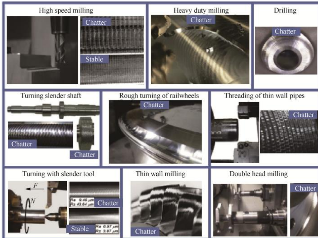
Slika 1. Primjeri utjecaja chattera kod različitih postupaka obrade [2]
