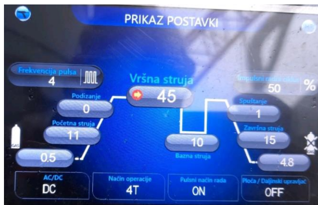
Slika 7. Parametri pulsnog TIG zavarivanja mrežice katalizatora
