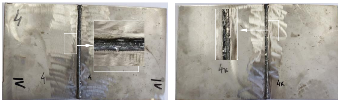
Slika 2. Izgled zavarenog spoja (lice i korijen)
