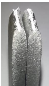
Slika 4. Epruveta OM3 nakon ispitivanja sa izraženom kontrakcijom
