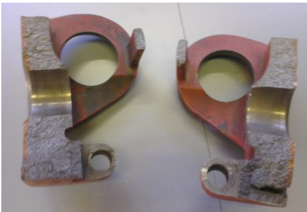
Slika 3. Polomljena pozicija prije sanacije METALOCK postupkom. [2]
