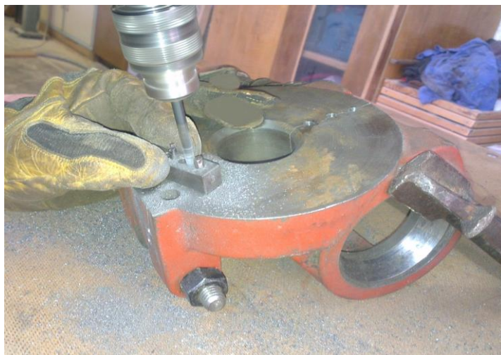
Slika 4. Bušenje rupa za METALOCK ključeve [2]
