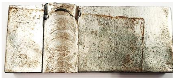
Slika 11. Naglo trošenje alata i stvaranje naljepka na obrađenoj površini
