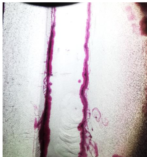
Slika 3. Greške naljepljivanja uslijed loše očišćene površine
