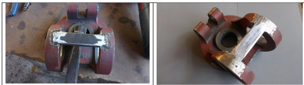
Slika 11. Raskivanje METALACE vijaka i brušenje površine. [2]
