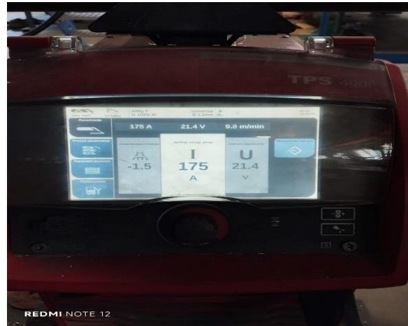
Slika 2. Unošenje neadekvatnih parametara za postizanje neprovara i nalepljivanja
