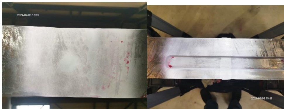
Slika 12. Izgled zavarenog uzorka nakon ispitivanja na lom i ispitivanja penetrantima
