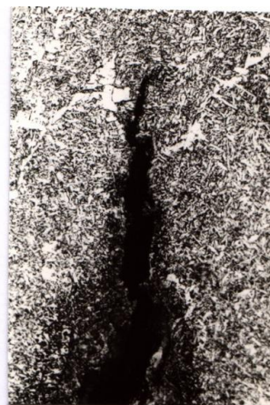
VRH HLADNE PUKOTINE
