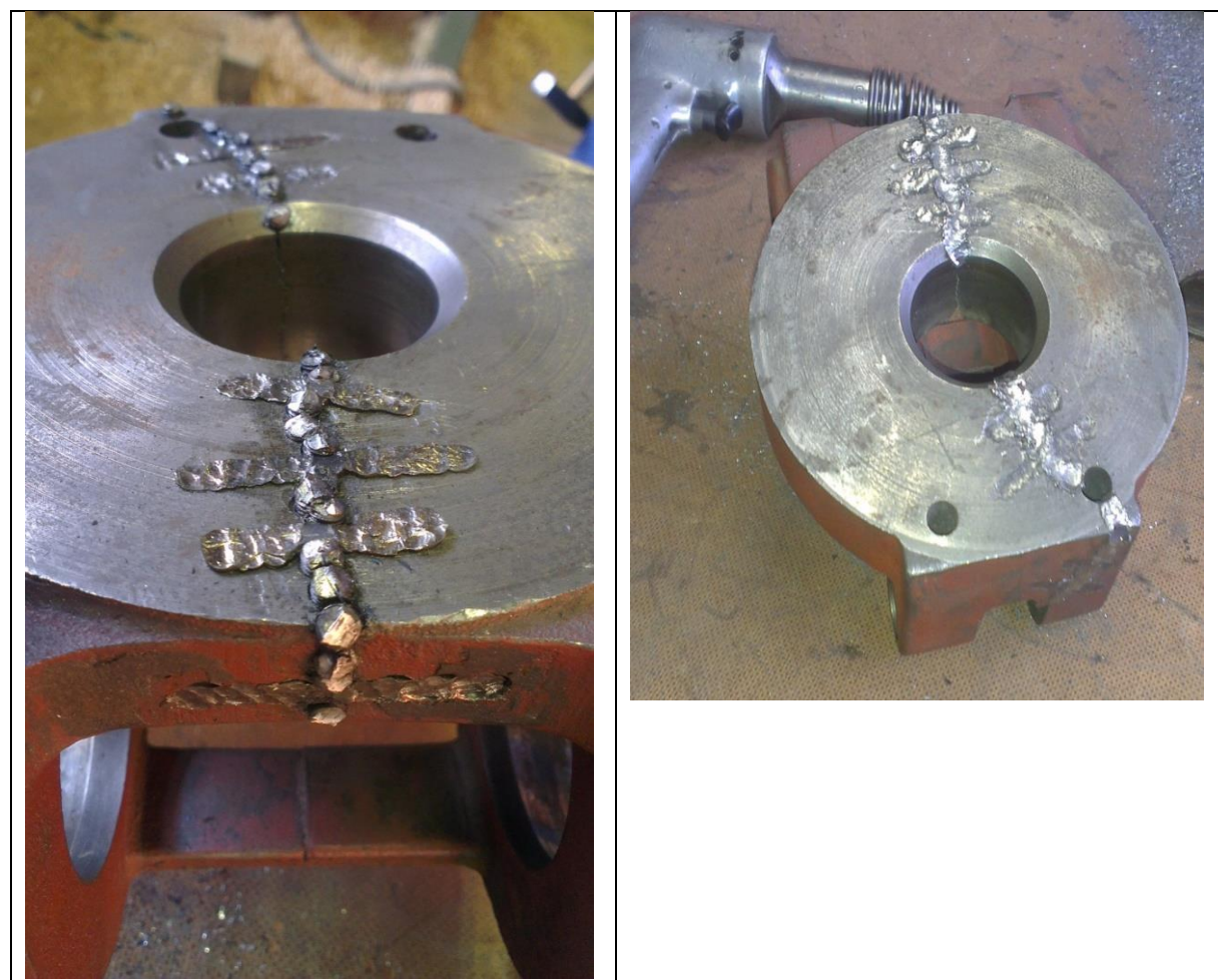
Slika 8. Raskivanje METALACE vijaka i METALOCK ključeva. [2]
