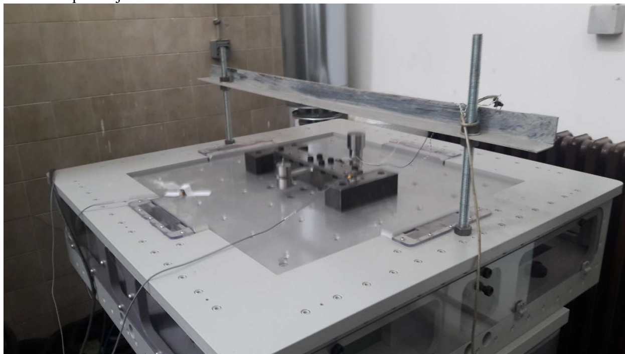
Slika 11 Sistem za ispitivanje dinamičke izdržljivosti zavarenih spojeva - epruvete stegnute u fiksatoru a ovaj učvršćeni zavrtnajskom vezom sa tablom šejkera
