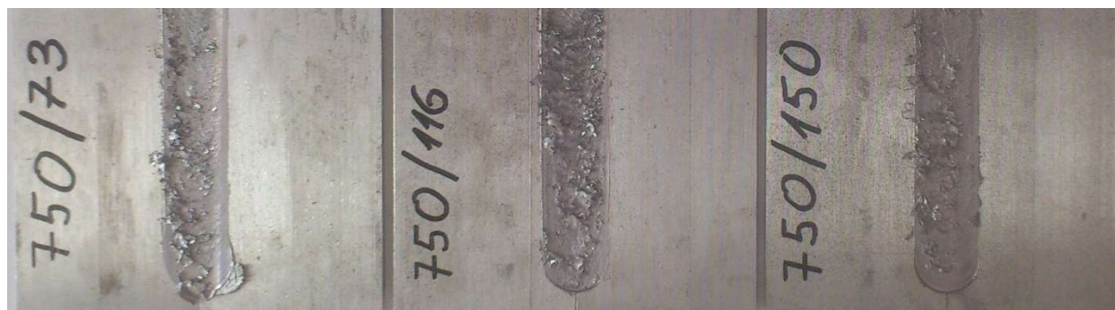
Slika 4 Izgled uzoraka od legure aluminijuma 2024 T351 zavarenih postupkom zavarivanja trenjem sa mešanjem
