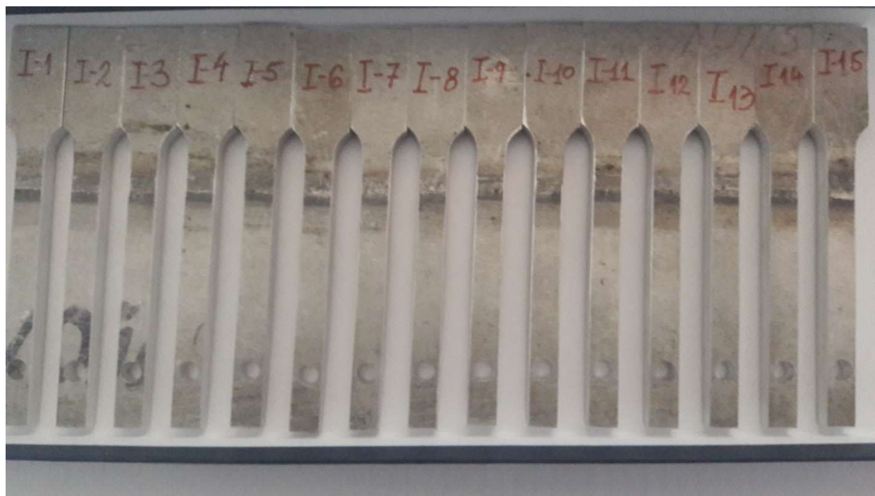
Slika 7 Izrađene epruvete iz FSW zavarenih uzoraka
