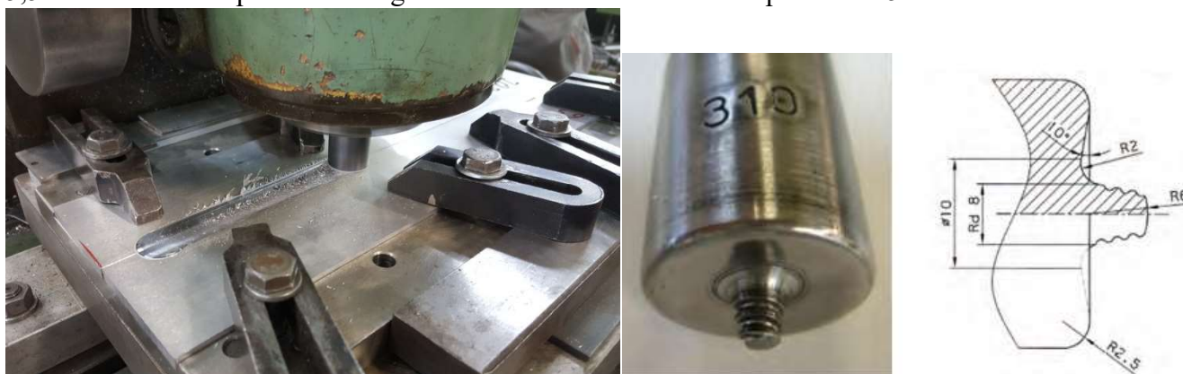
Slika 3 a) Proces zavarivanja trenjem sa mešanjem; b) alat za zavarivanje
