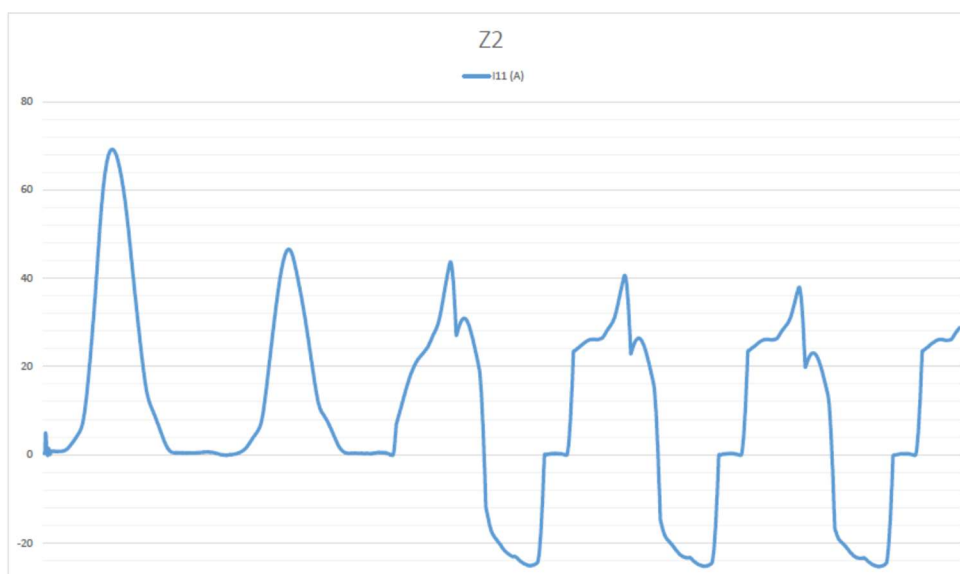
Slika 9 Valni oblici uklopne struje prve faze primara za prazni hod i zatim opterećenje transformatora, 2016. (autor: Ivan Petrović)
