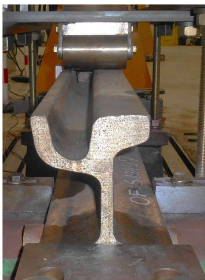
Slika 17 Osa opterećenja se poklapa sa odgovarajućim neutralnim vlaknom nakon 3000000 ciklusa
