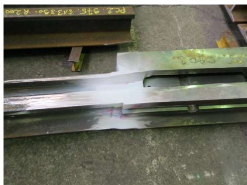
Slika 10 Izgled zavarenog spoja šina-blok
