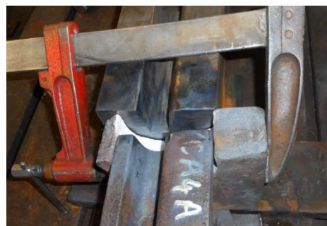
Slika 5 Postavljane bakarnih podmetača za zavarivanje vrata šine za blok
