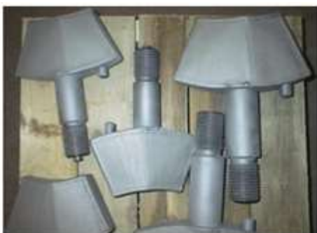
Slika2 Izgled novih zuba i djelimično pohabane zavojnice
