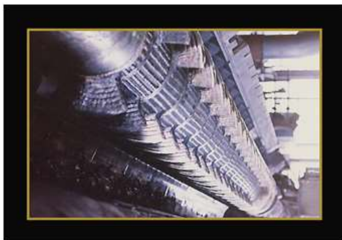
Slika1 Izgled kućišta i rotora mješalice za pripremu anodne mase u otvorenom položaju [1]
