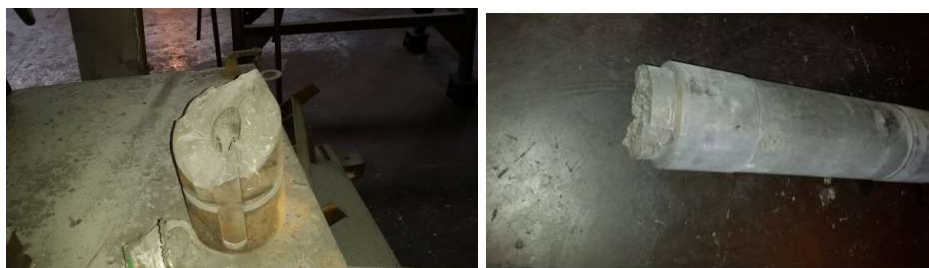
Slika 5 Izgled polomljenog vratila poslije loma po rukavcu prečnika \varnothing 165 mm
