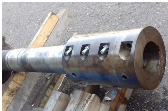
Slika 9 Izgled dijela reparaturno zavarenog vratila sa kontrolnikom
