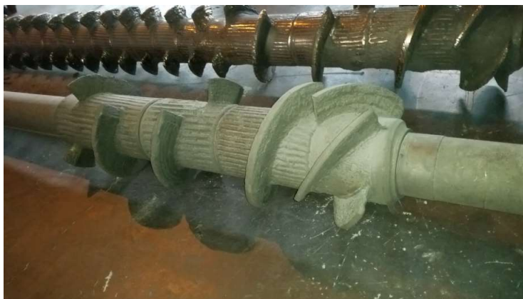
Slika 3 Izgled elemenata za miješanje anodne mase i vratila miksera poslije izvjesnog vremena u radu[2]
