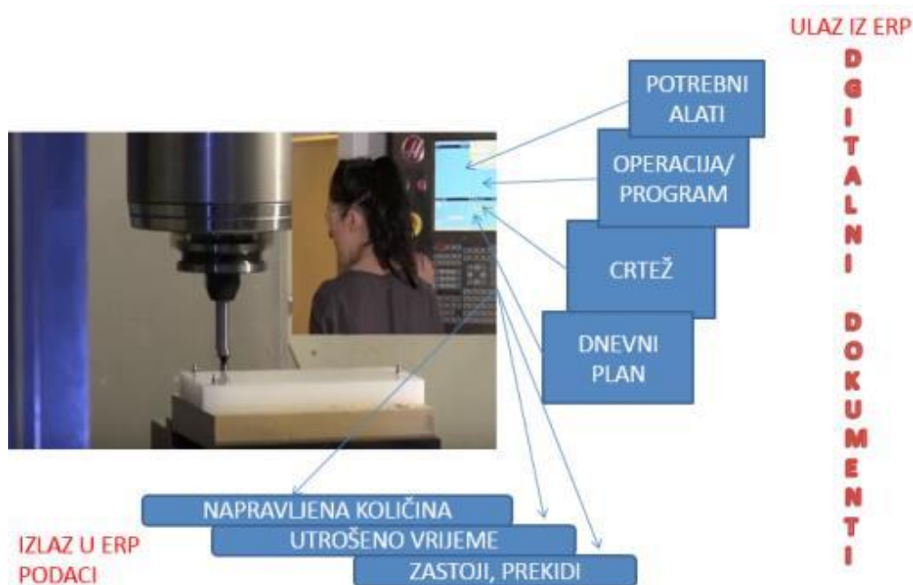
Slika 4. Primjer digitalnog strojnog radnog mjesta u proizvodnji
